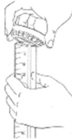
Figure III-37 : Retrait du bouchon du fond en élastomère
