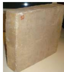
Figure. 2. Echantillon parallélépipédique de Cématerre pour l'essai de la Boite chaude « Mesure de la conductivité thermique »
