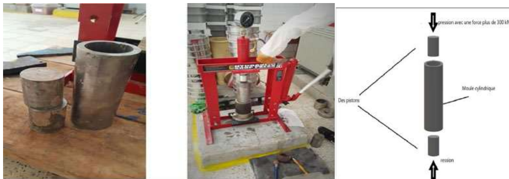
Figure 3. Moule et presse manuelle de compactage et extraction
