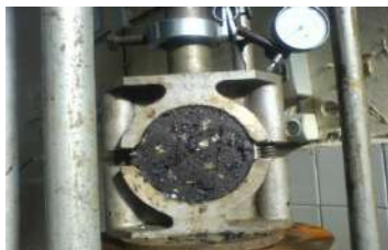
Figure.5 : Stabilité suivant Marshall
