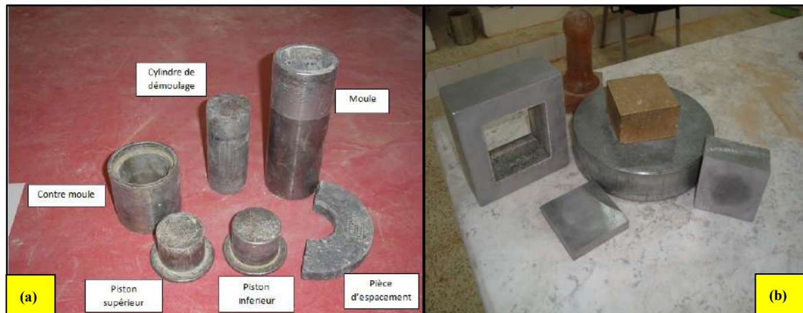
Figure. 1. Moule de confection d'éprouvettes pour la compression simple (a), et cisaillement direct (b).
