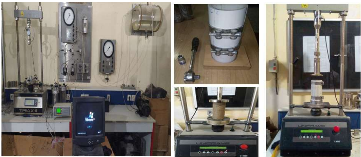
Figure. 2. Vue générale de l'appareil triaxial et de la machine de compression simple.
