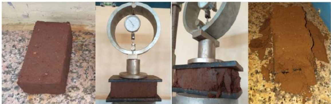
Figure 5. Brique BTC avant et après écrasement
